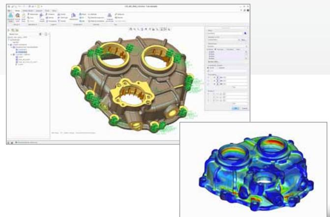
Creo Simulate ermöglicht die Modellanalyse zur schnellen Identifizierung problematischer Bereiche. Nach der Aktualisierung der Konstruktion kann die Analyse einfach wiederholt werden, ohne dass eine Neuerstellung notwendig ist.
