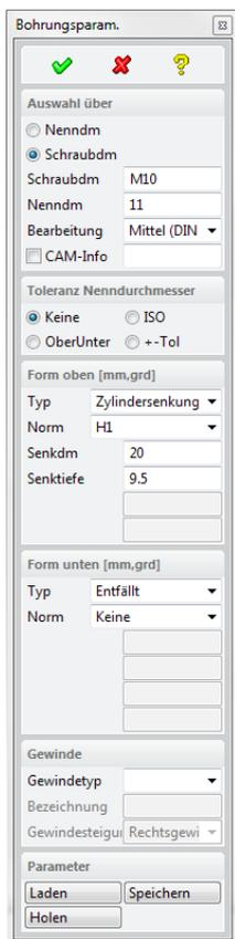
Bohrungsparameter können nach DIN oder benutzerdefiniert eingegeben werden. Bohrungen durch mehrere Teile und Bohrmuster werden unterstützt. Nachträgliche Änderungen von Bohrungen wie Kopieren, das Ändern von linearen und radialen Lochbildern sowie des Lochkreisdurchmessers sind ebenso möglich wie das Umkehren von Bohrungen und Teilgewinden.
