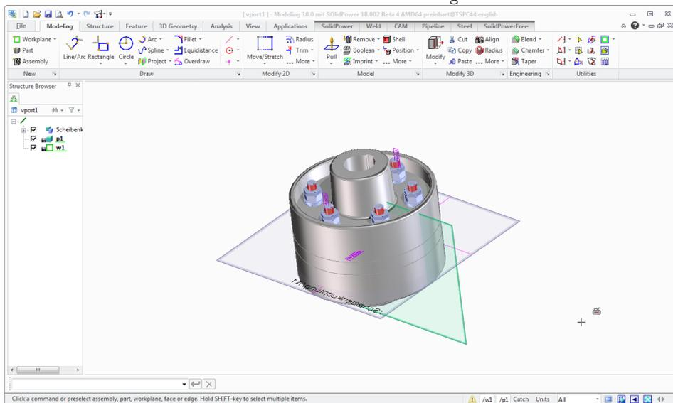
Dank Creo Elements/Direct Model Manager-Integration können alle Daten und Normteile sowie selbst erzeugte Normteile über eine direkte Schnittstelle im Model Manager verwaltet werden. Somit können den einzelnen Normteilen Artikelnummern zugeordnet und diese in der PDM-Datenbank in Verbindung mit der Konstruktion verwaltet werden.
