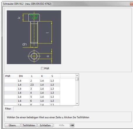
Das nachträgliche Ändern von Schraubenverbindungen ist ebenfalls menügesteuert möglich, dabei wird auch die zugehörige Bohrung geändert. Beim Ändern von Bohrungen können sowohl einzelne Bohrungen, Baugruppen-Bohrungen und Bohrmuster geändert werden; Änderungen der Bohrungsart und der Senkungen sind ebenfalls möglich.
